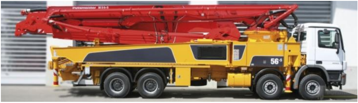
Рисунок 1.3 – Автобетононасос М 56-5, М 56-5.16 Н
