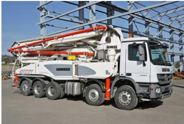
Рисунок 1.7 – Автобетононасос LIEBHERR 47 M5 XHT
