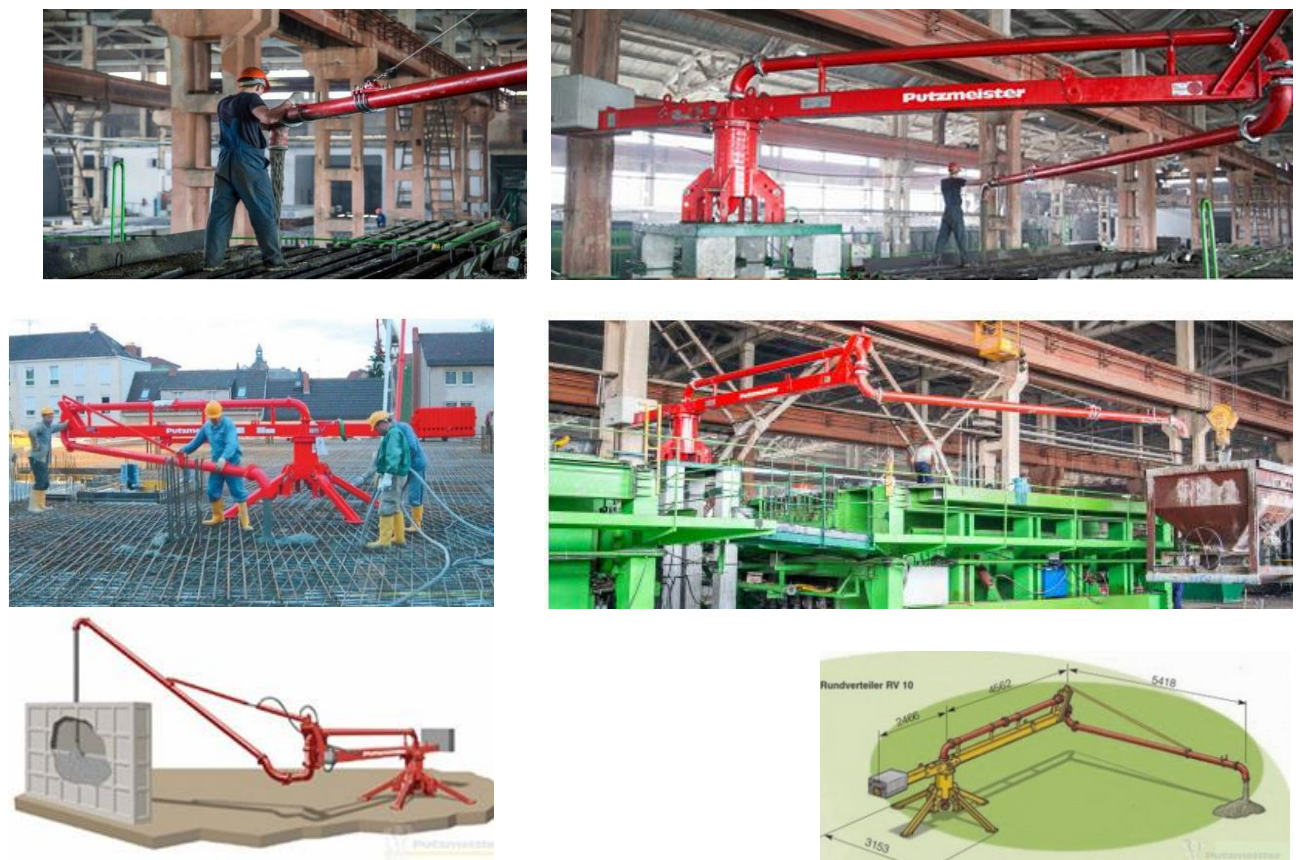
Рисунок 1.5 – Робота та схеми кругових механічних розподільних стріл
