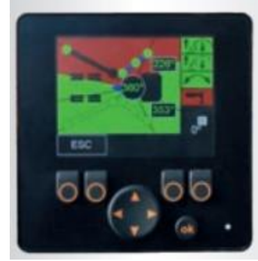
Рисунок 1.14 – Система управління опорами
