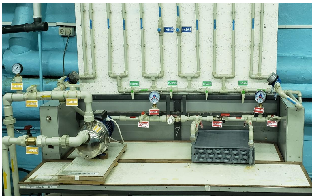
Рисунок 1.6 – Технологічна схема установки перевірки гідравлічних та місцевих опорів комунікацій
