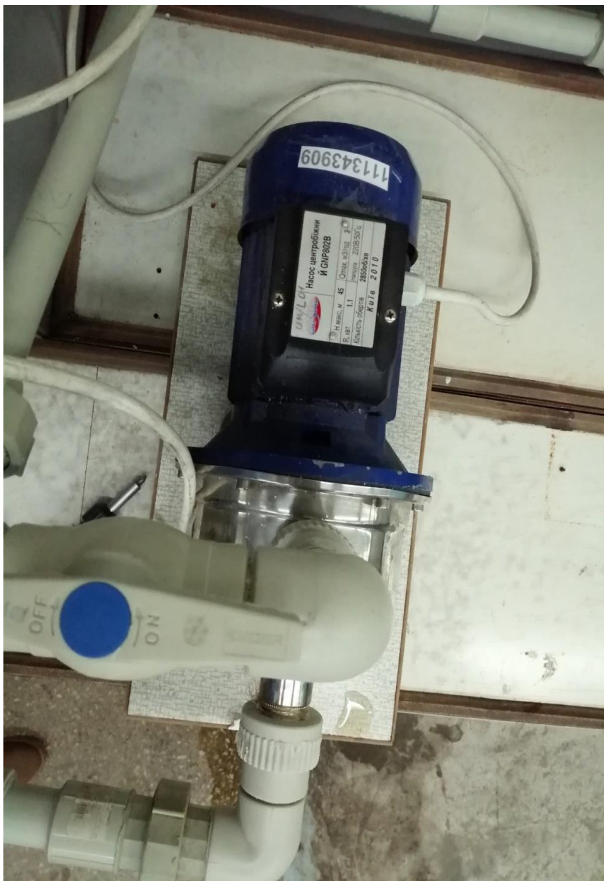
Рисунок 1.4 – Циркуляційний насос лабораторної установки
