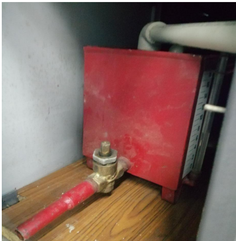
Рисунок 1.5 – Циркуляційний бак лабораторної установки
