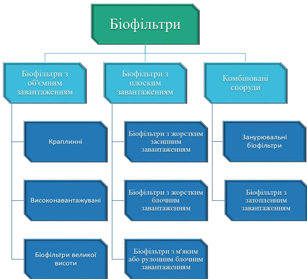
Рисунок. 1.4 Класифікація біофільтрів за видами завантажувального матеріалу
