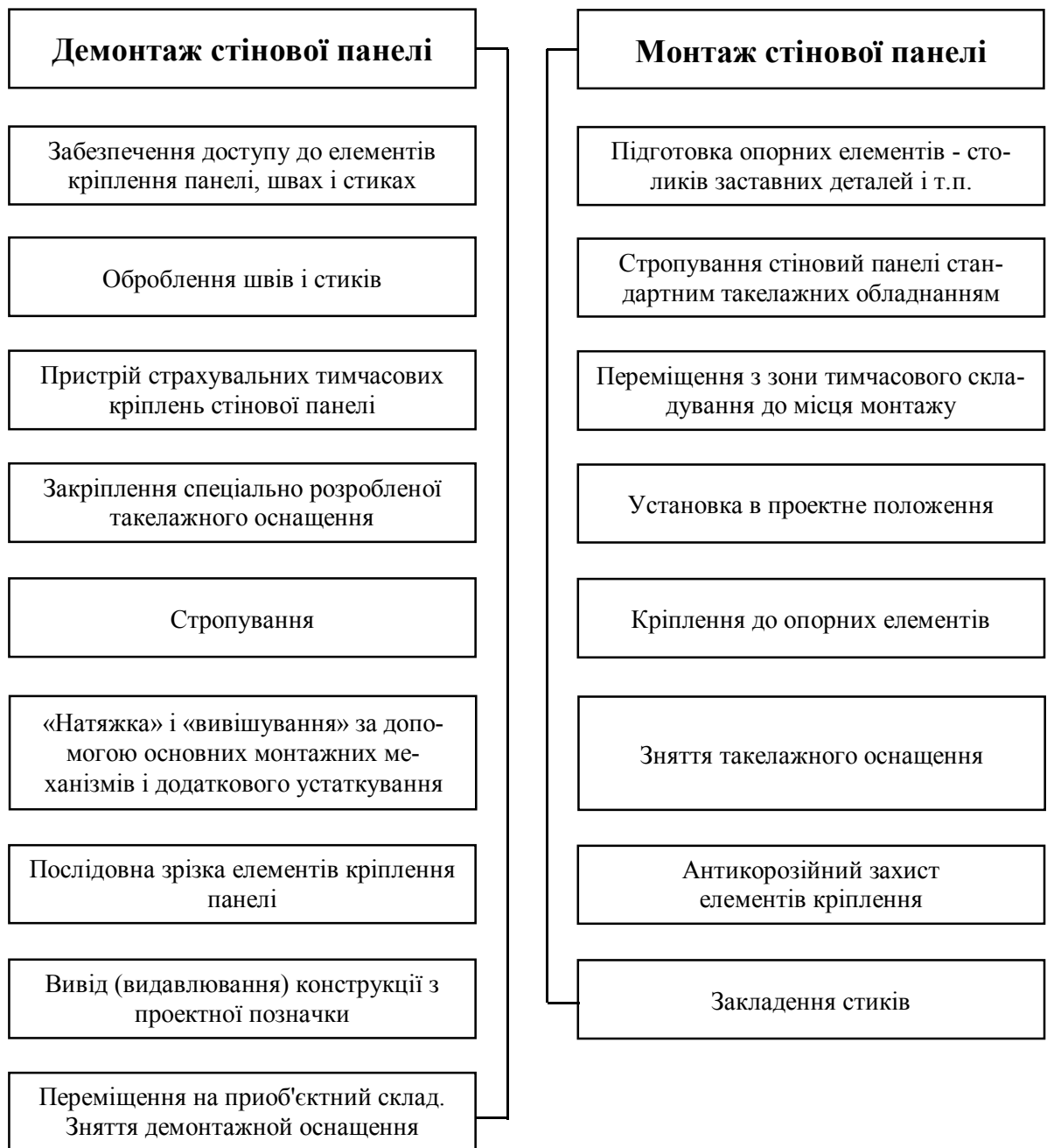
Рисунок 2.1 - Склад технологічних процесів монтажу і демонтажу конструкцій
