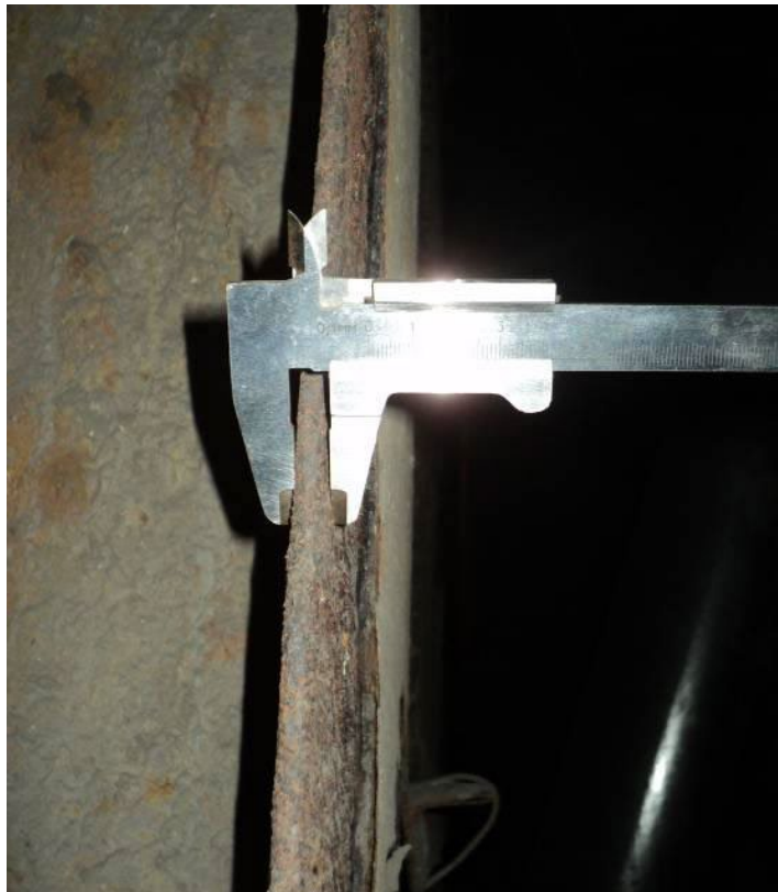
Рисунок 4 – Заміри полки колони без корозії
