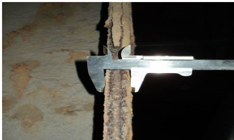
Рисунок 3 – Заміри полки колони з продуктами корозії
