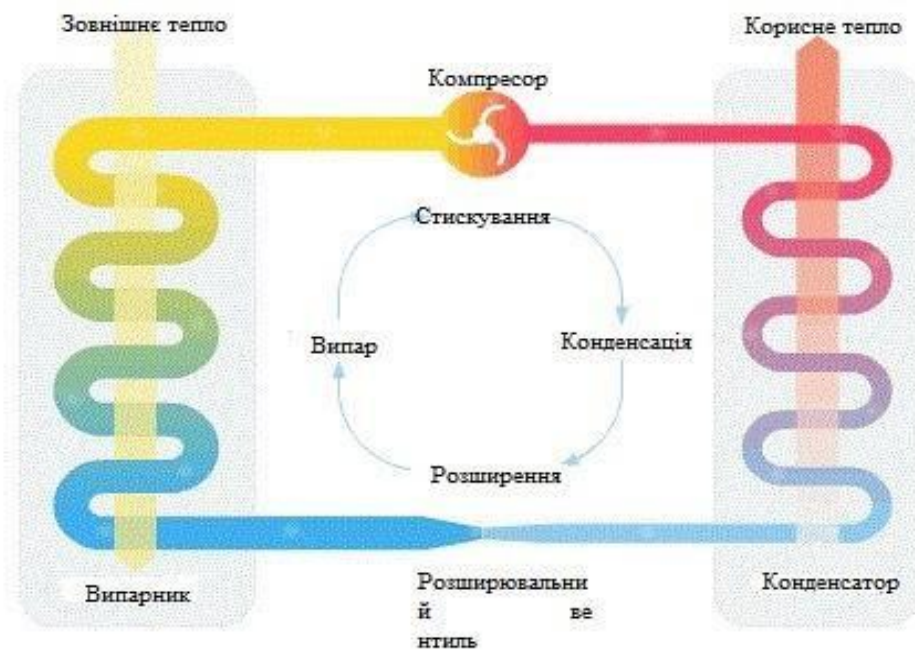
Рисунок 1.6 – Принцип роботи теплового насосу
