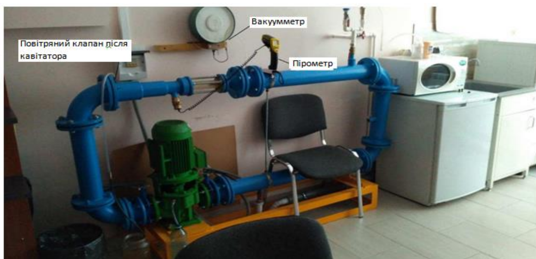
Рисунок 3.7 – Загальний вид експериментальної установки після проведених перетворень
