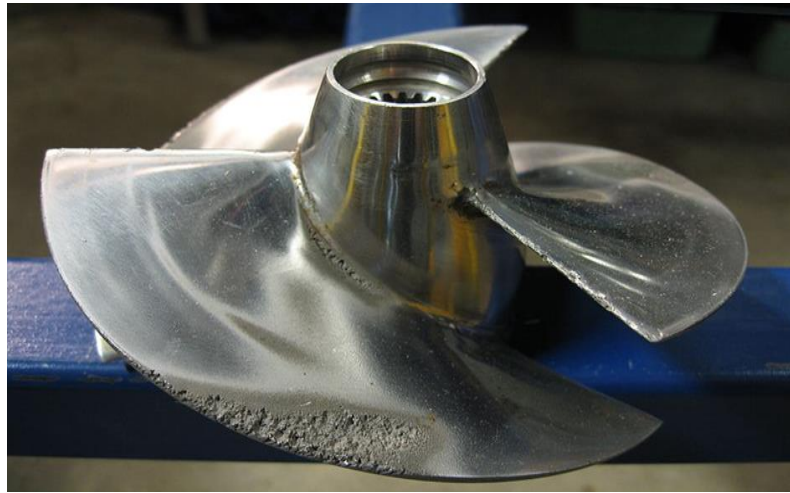
Рисунок 1.1 – Лопатки, що зазнали кавітації
