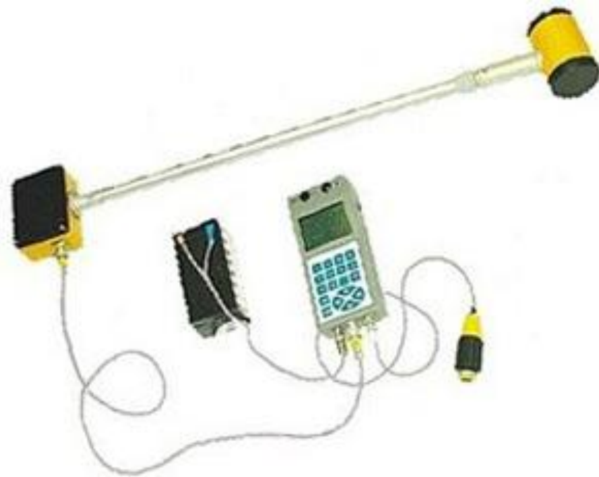
Рисунок 2.2 – Одноканальний протонний магнітометр
