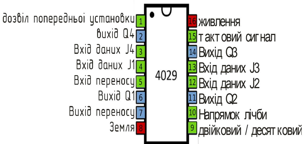
Рисунок 2.11 – Мікросхема CD4029
