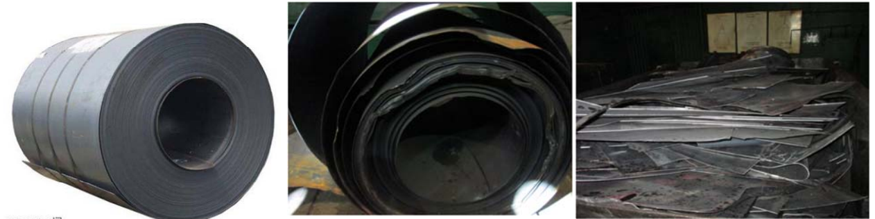
а) гарячекатаний рулон; б) гарячекатаний рулон з завальцюванням; в) відходи після обрізу рулону.
