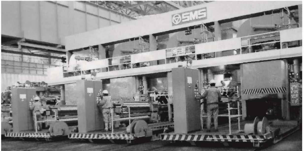
Рисунок 1.6 – Неперервний стан – тандем з пристроями для перевалки валків
