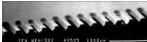
Рисунок 4.24 - Хімічно фрезерований трафарет
