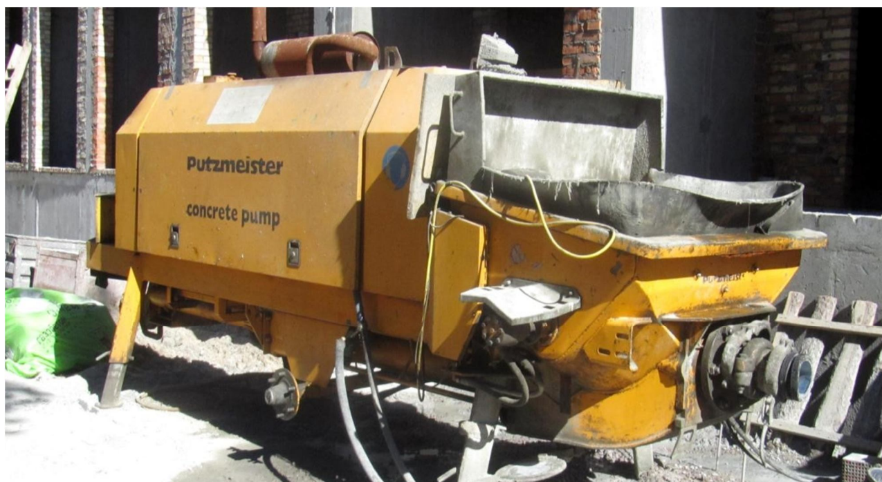
Рисунок 2.4 – Стационарний бетононасос “Putzmeister”
