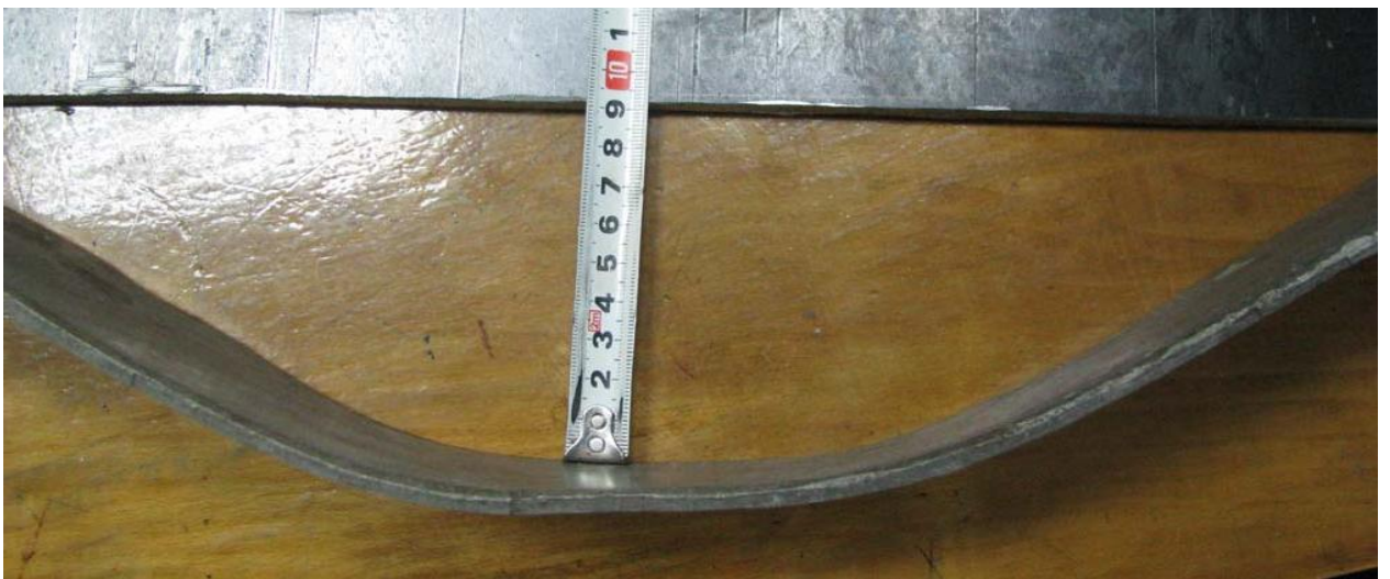
Рисунок 3.13 – Фото зразка №3 до правки
