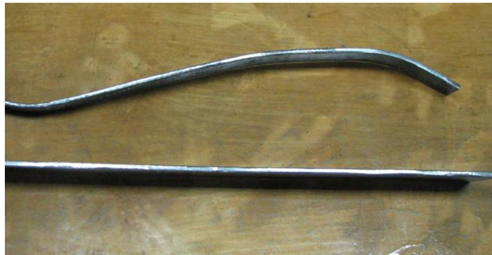
Рисунок 3.14 – Фото зразків до та після виправлення
