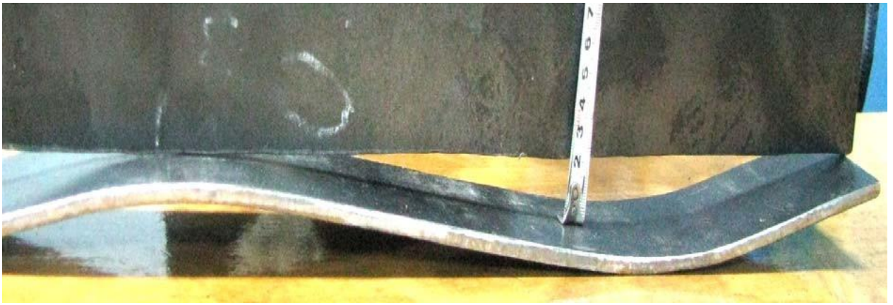
Рисунок 3.12 – Фото зразка №2 до правки
