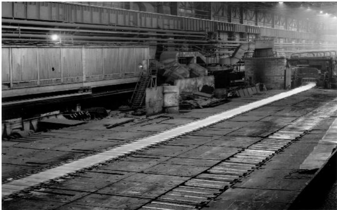
Рисунок 1.6 - Рух слябу по нижньому пічному рольгангу на стан гарячого прокатування 1680
