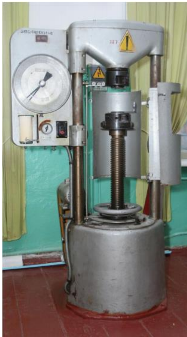
Рисунок 2.2 – Загальний вигляд випробувальної машини КМ-50 [24, 25]
