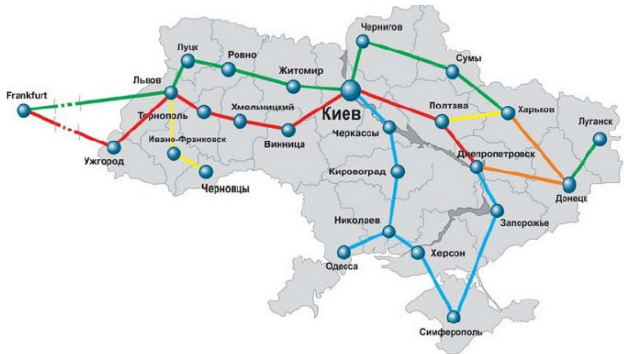
Рисунок 2.4 – Схема міжміської оптичної мережі ПрАТ «ДАТАГРУП»
