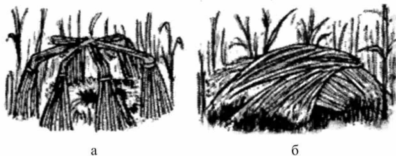
Рис. 10. Намет з очерету а- каркас; б - готове укриття
