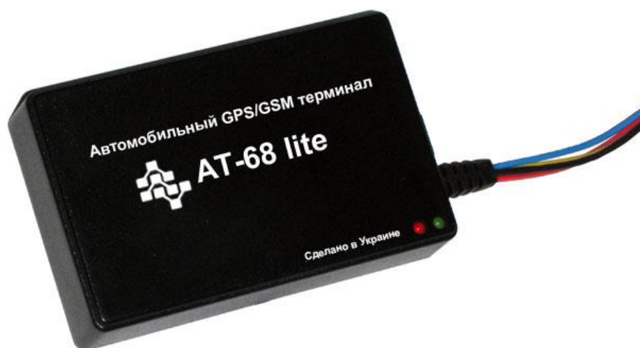
Рисунок 3.3 – Система GPS стеження і контролю палива за нормовитратами - система FMS-T [43]
