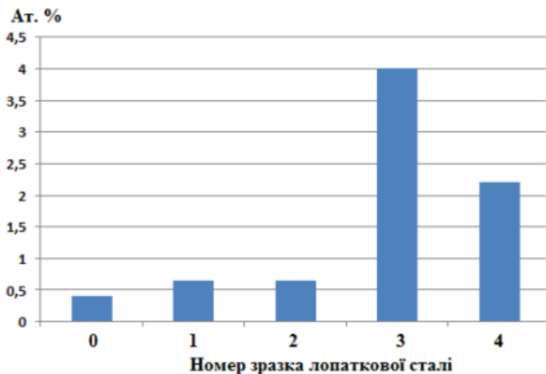
Рисунок 2.7 – Вміст водню в зразках сталі
