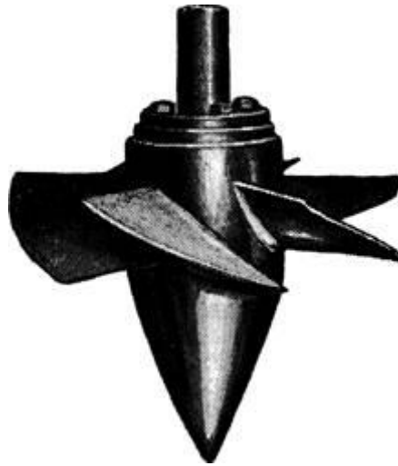
Рисунок 1.7 – Поворотно-лопатева турбіна Каплана
