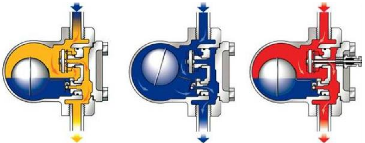
Рисунок 1.13 - Принцип роботи конденсатовідвідника з термостатичним повітряником
