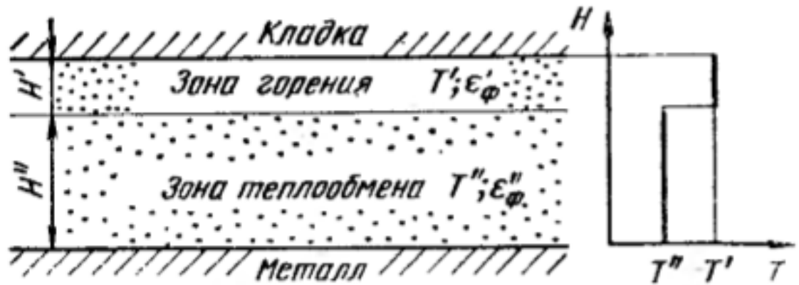
Рисунок 2.1 - Схема теплообміну в печі з плоскополум'яними пальниками
