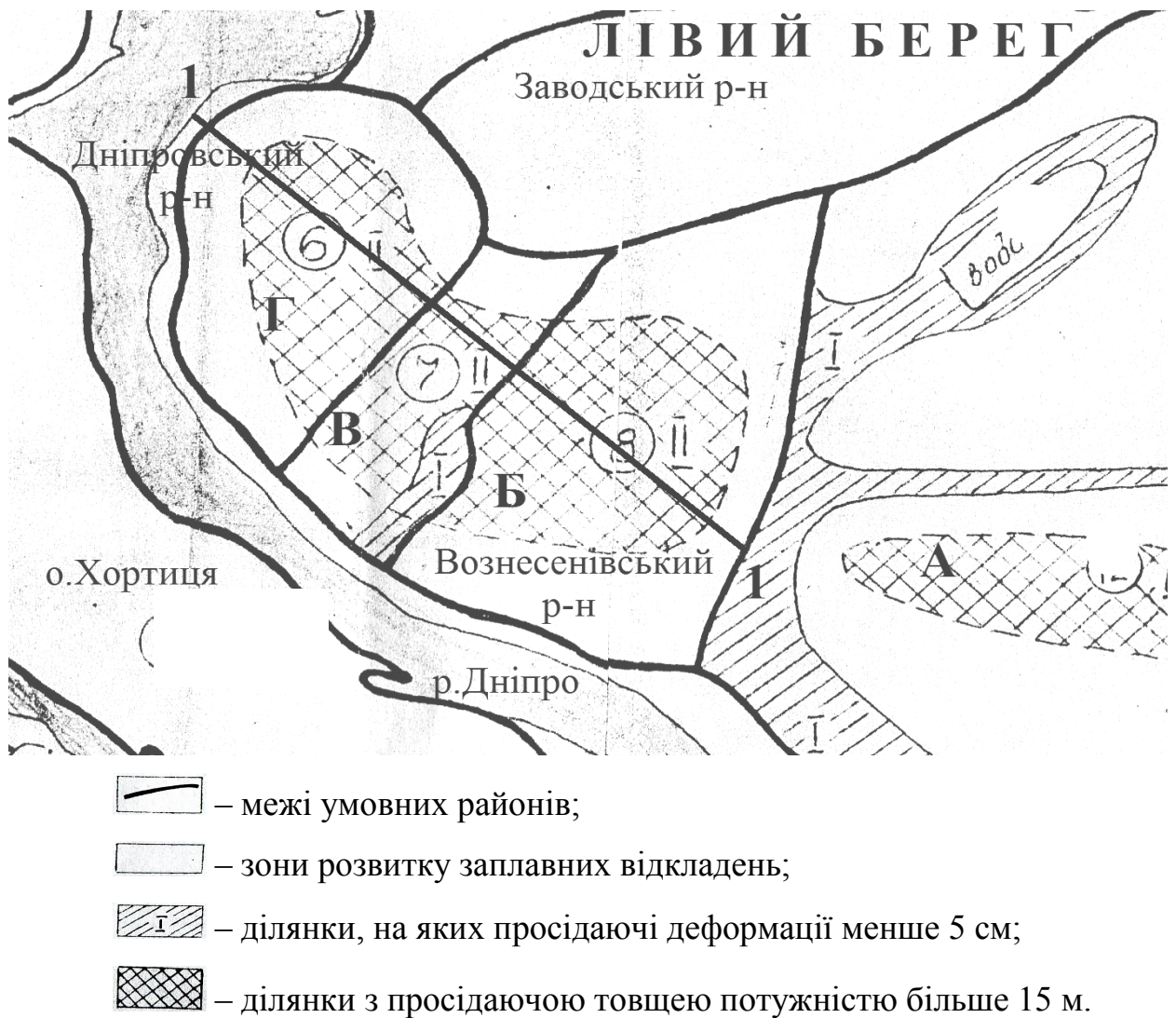
Рисунок 3.3 – Схематична карта ґрунтових умов зони м. Запоріжжя, що розглядається: 6...8 – умовні райони за ґрунтовими умовами; I...II – ділянки території за типом просідання; А...Г – зони розвитку надзаплавних терас Дніпра; 1-1 – лінія інженерно-геологічного розрізу
