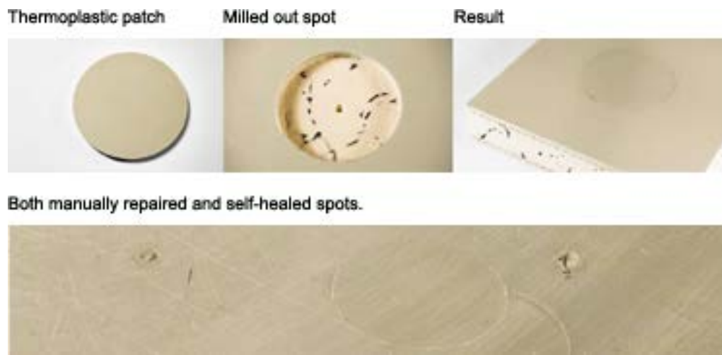
Рисунок 3.12. Ремонт та відновлення панелі Sonoboard.
