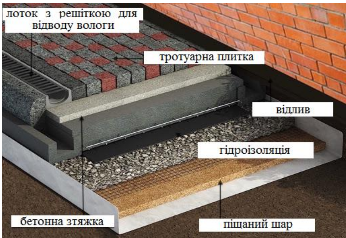
Рисунок 2.14 – приклад влаштування вимощення
