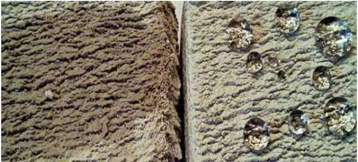
Рисунок 3.1 – Бетон без гідрофобних добавок та з ними
