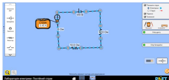
Рисунок 2.19 – Вимірювання сили струму між вимикачем та другим резистором
