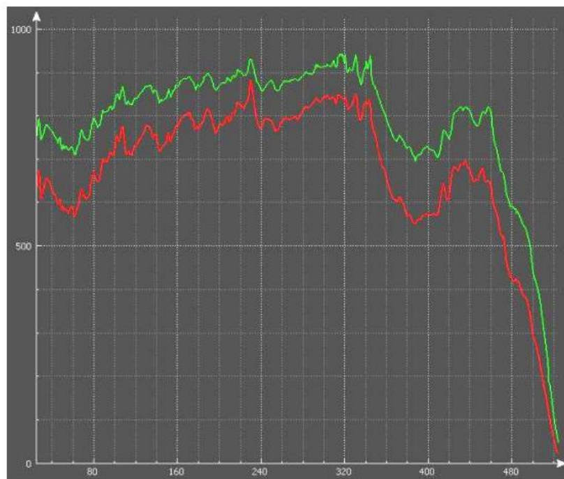
Рисунок 2.9 – Графіки зміни освітленості (по горизонтальній осі відкладені номери вимірів, проміжок між вимірами складає 1,5 хв; по вертикальній осі відкладена освітленість у відносних одиницях)
