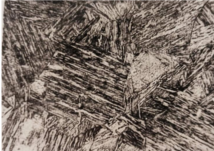
Рисунок. 3.3 – Мікроструктура сталі 19X14H2M-ш після термічної обробки x800
