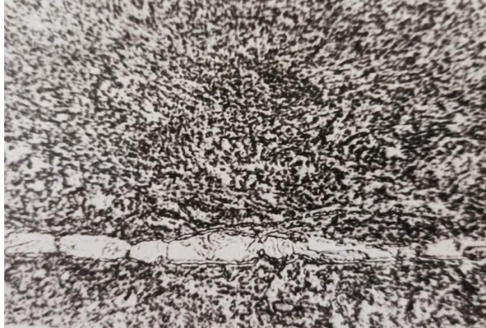
Рисунок.3.1 – Мікроструктура сталі 18X15H2M-ш – включення фериту, аустеніту та мартенситу, x800
