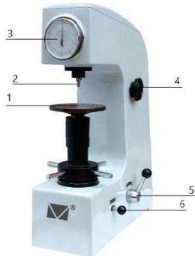
Рисунок 2.3 – Твердомір «Роквелл» модель HRA-1: 1 – робочий стіл; 2 – індендор; 3 – індикатор; 4 – ручка переключення навантаження; 5 – ручка розвантаження; 6 – ручка навантаження [39]
