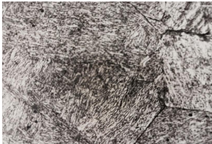
Рисунок. 3.2. – Мікроструктура сталі ЭИ961– мартенситна структура, x800
