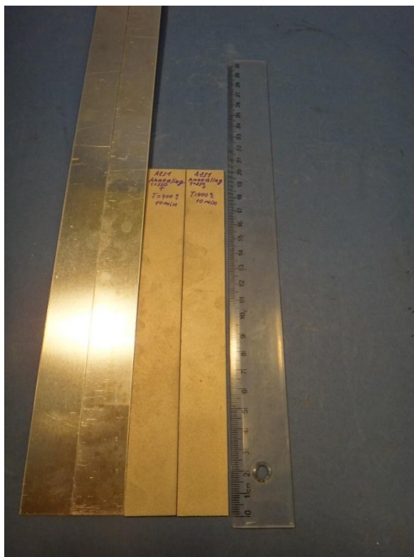
Рисунок 2.2 – Зовнішній вигляд зразків з алюмінієвого та магнієвого сплавів перед збиранням пакетів
