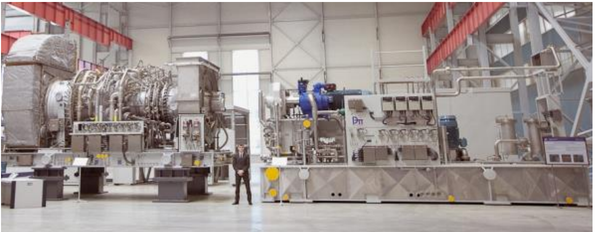
Рисунок 1.8 – Блок газотурбінного двигуна з патрубками входу/виходу (зліва) та рама допоміжних пристроїв (праворуч) [2]
