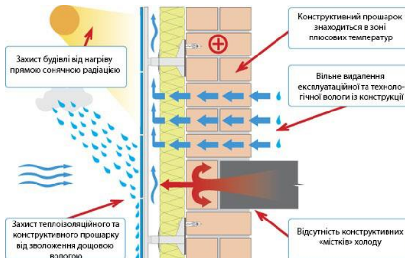
Рисунок 1.2 – Вентильований фасад
