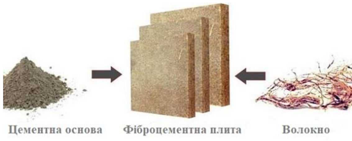
Рисунок 2.6 – Склад фіброцементних плит
