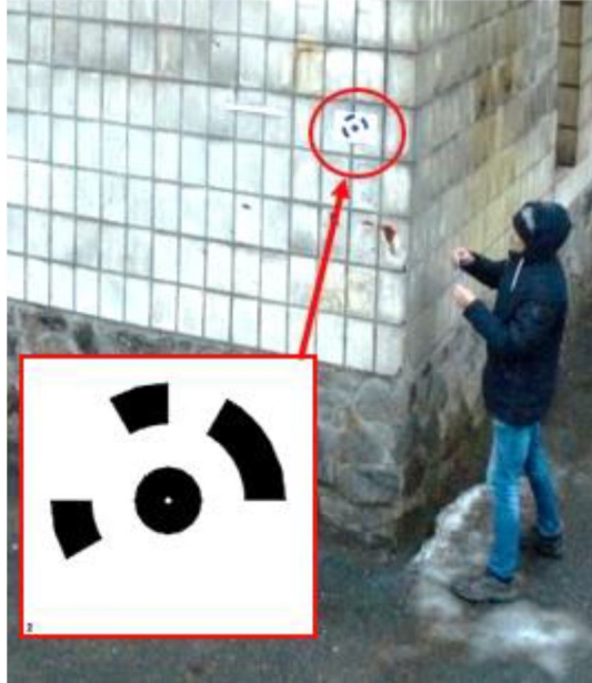
Рисунок 3.5 - Встановлення роздрукованих маркерів на фасад для авторозпізнавання
