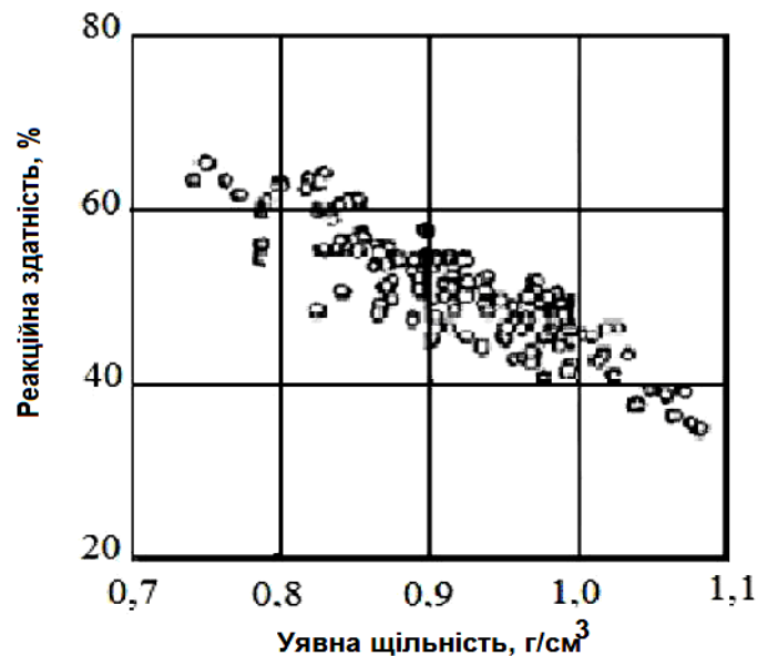
Рисунок 1.4 - Залежність між уявною щільністю і реакційною здатністю при 1400 °С [13]
