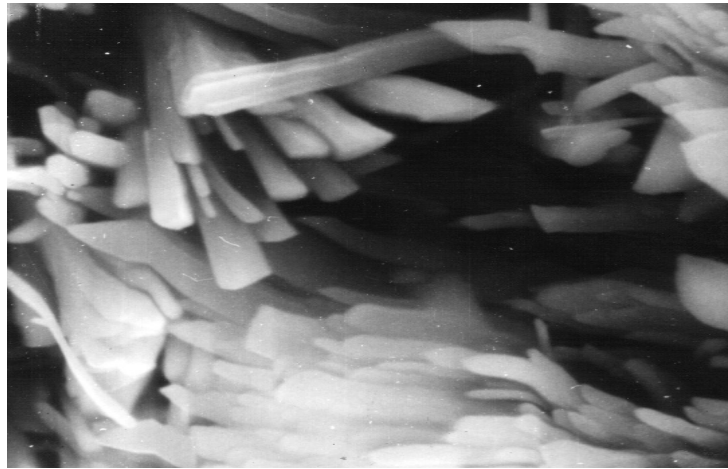
Рисунок 2.7 - Мікроструктура каменю на основі бездобавочного гіпсового в'язучого з фосфогіпсу
