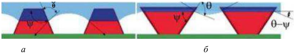
а, б - кордон розділу рідина-пара на двох поверхнях з різними значеннями рівноважного контактного кута
