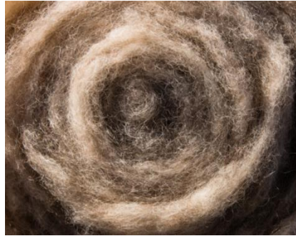
Рисунок 1.8 – Теплоізоляційний матеріал з вівчаної шерсті (овеча вовна)
