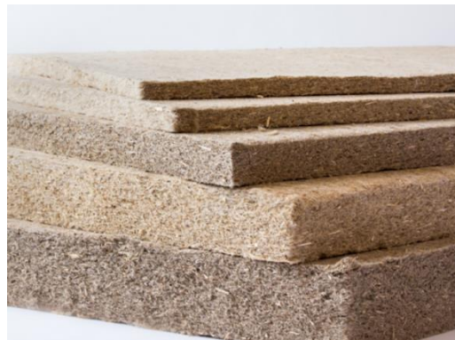
Рисунок 1.10 – Теплоізоляційний матеріал з конопляних рослин
