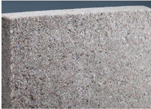
Рисунок 1.6 – Теплоізоляційний матеріал целюлозна ізоляція
