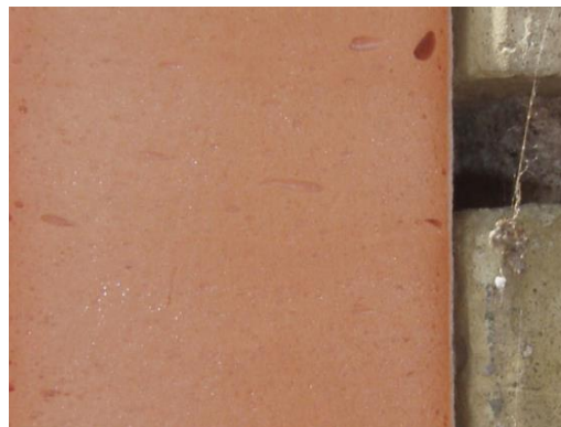
Рисунок 1.16 – Теплоізоляційний матеріал з фенолформальдегідної піни
