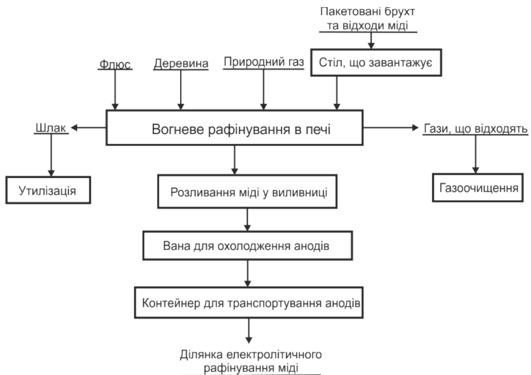
Рисунок 2.4 – Технологічна схема виробництва мідних анодів в печі вогневого рафінування
