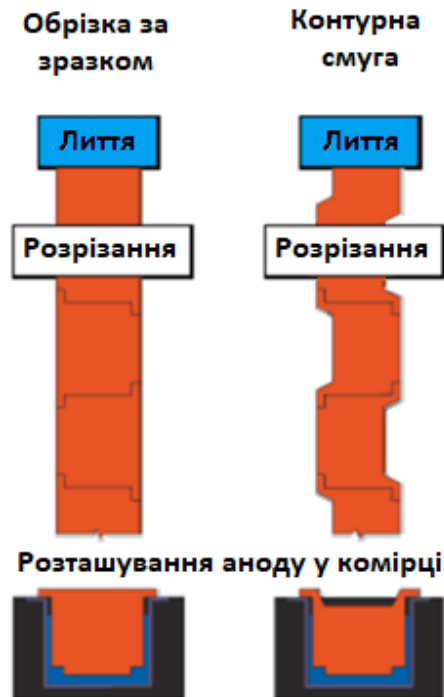
Рисунок 2.10 – Різка безперервно литих анодів
