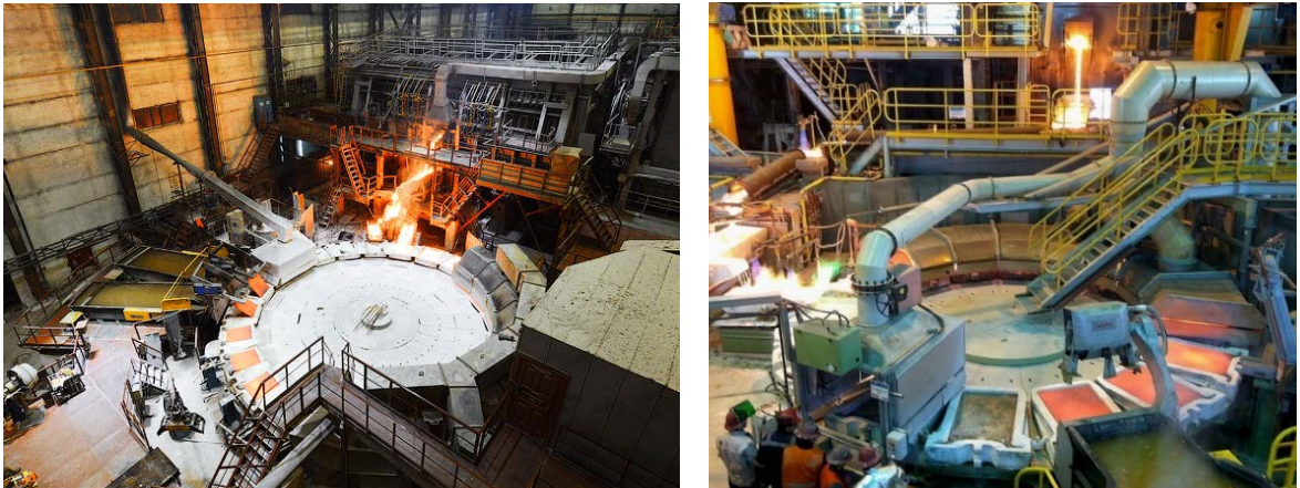
Рисунок 2.5 – Загальний вид ливарної машини для розливання анодів карусельного типу з одним колесом [20]
