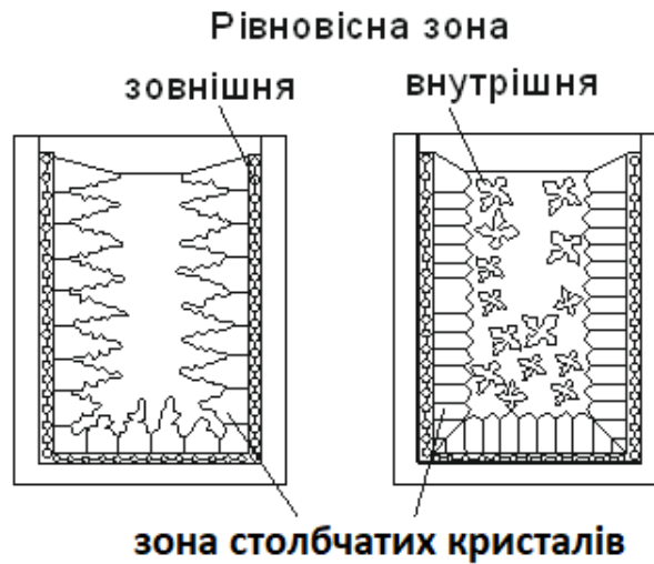
Рисунок 3.1 – Структури затвердіння в виливках
