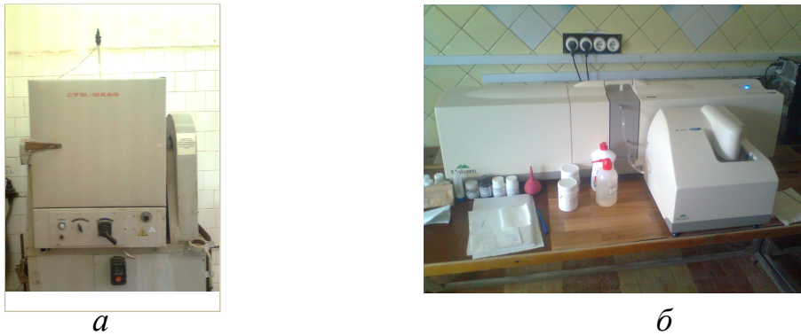
Рисунок 2.1 – Сушильна шафа (а) і спектрометр Mastersizer (б)
