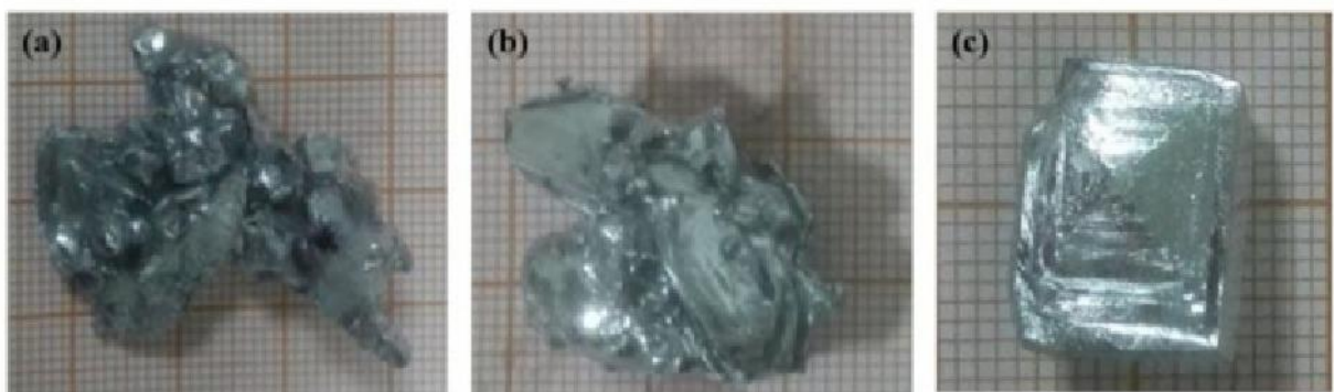
Рисунок 2.4 - Кристалічна морфологія рідкого галію після 15-хвилинного додавання ядер при різних температурах охолоджуючої води ((a) 288 К, (b) 290 К і (c) 293 К)
