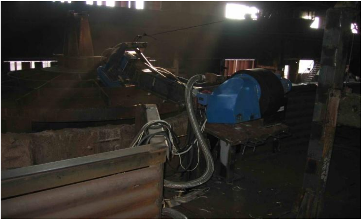
Рисунок 2.1 - Пальникові пристрої СНП на вертикальному посаді сушіння сталерозливних ковшів ПАТ «Запоріжсталь»;
