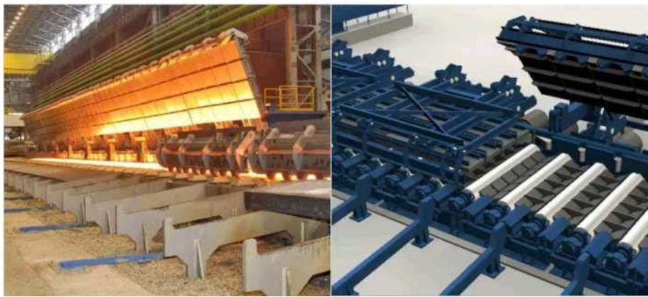
Рисунок 1.9 – Тепловий екран типу «енкопанель»
