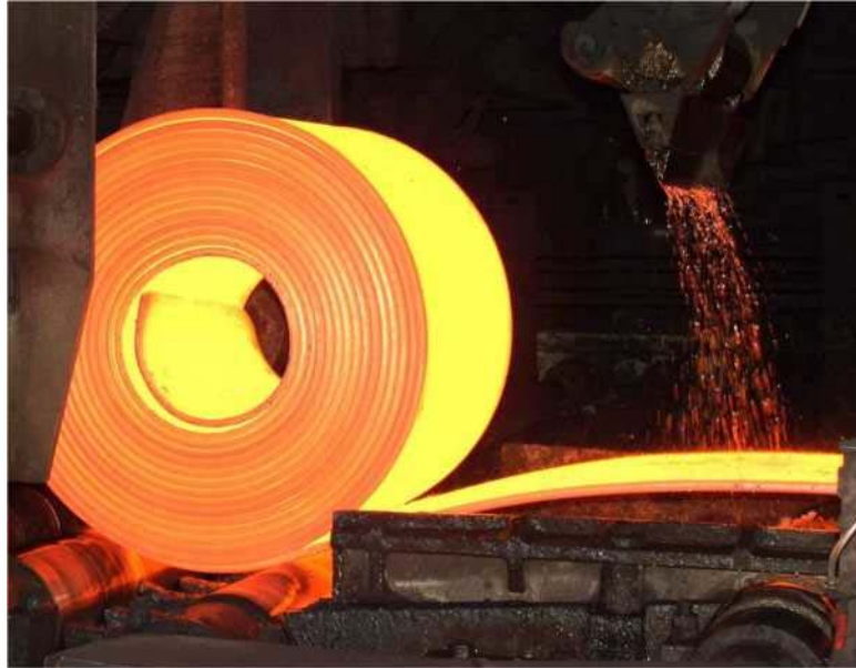
Рисунок 1.12 – Проміжний перемотуючий пристрій без передачі рулону
