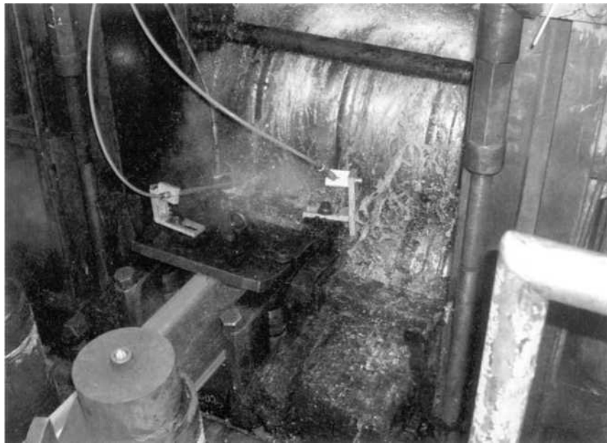
Рисунок 2.9 – Подача мастила в калібр кліті сортового стана
