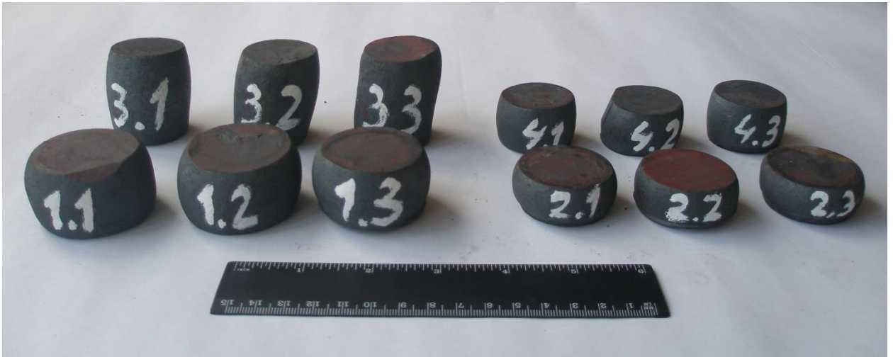
Рисунок 3.7 – Зразки після осадки: а) зображення зразків; б) схема проведення аналізу мікроструктури: I – у центрі зразку, II – на боковій поверхні, III – на поверхні контакту з деформуючим інструментом.
