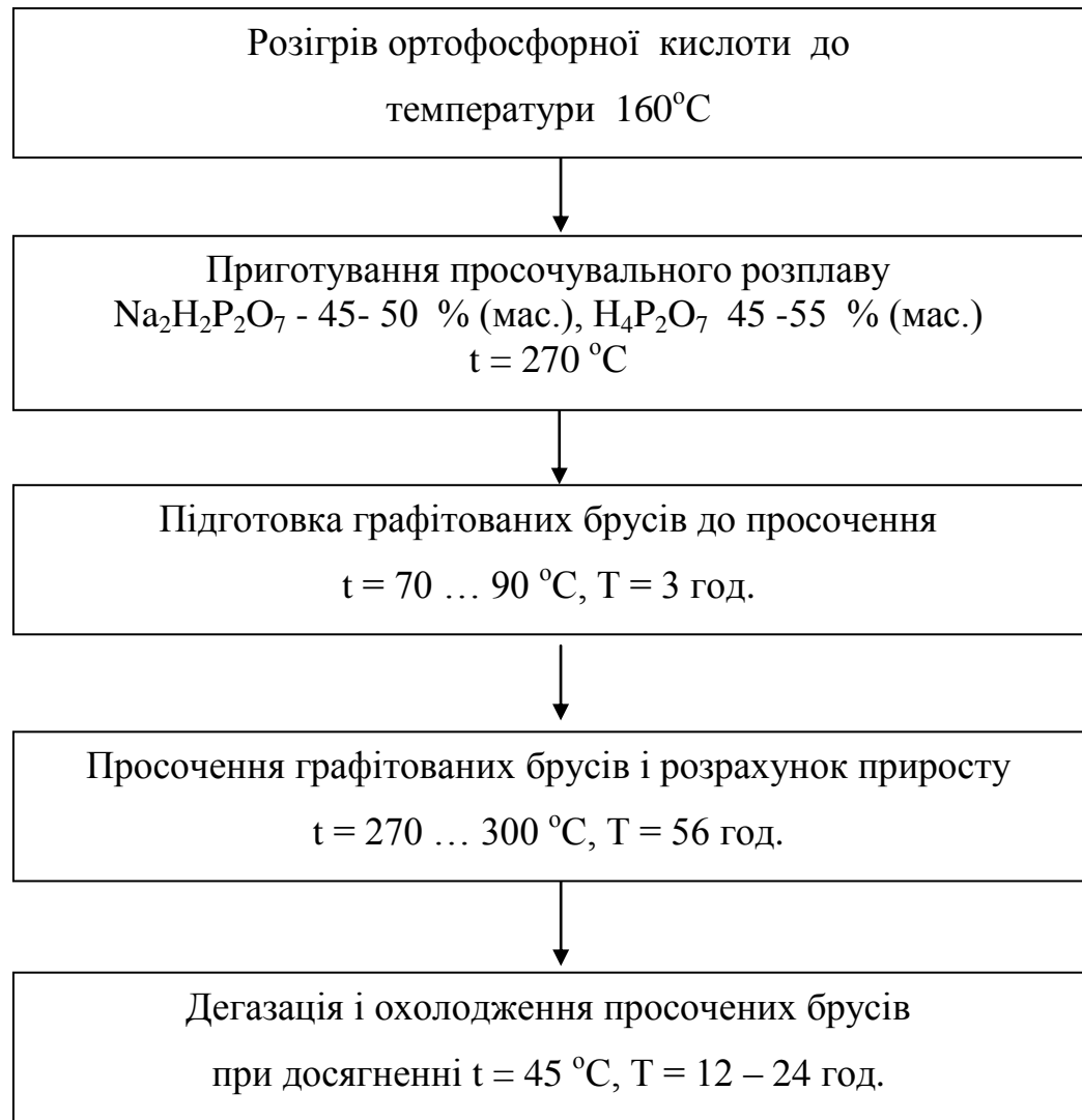
Рисунок 1.2 – Загальна технологічна схема виробництва
