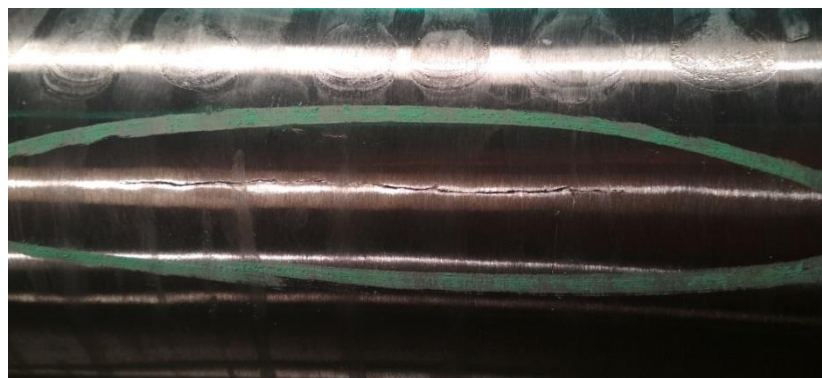
Рисунок 3.3 - Розкатана тріщина (на металі після шлифування).
