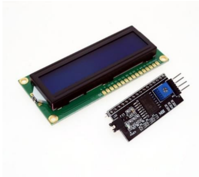
Рисунок 1.16 – Дисплей LCD1602 та конвертор в ІС/І2С
