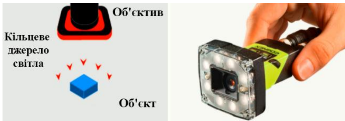
Рисунок 2.1 - Інтегроване джерело світла с дифузійним кільцем
