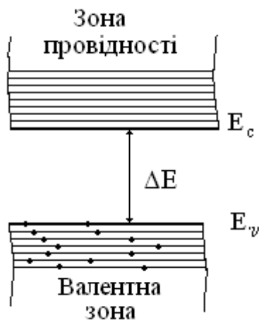
Рисунок 1.4 - Структура енергетичних зон напівпровідника
