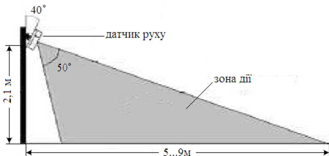
Рисунок 2.25 – Установка ІЧ-датчика
