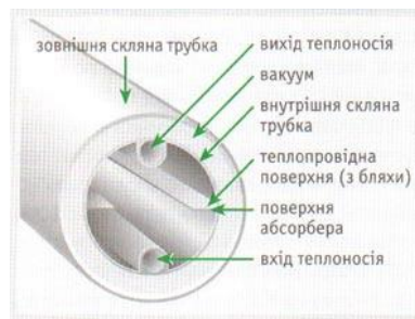
Рисунок 2.4 – Переріз трубопроводу колектора
