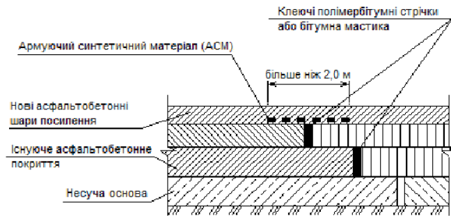
Рисунок 2.4 – Схема поширення конструкцій дорожнього одягу з використанням АСМ (вигляд у поперечному напрямку)
