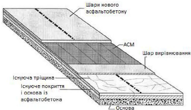
Рисунок 2.8 – Схема армування при реконструкції шарів дорожнього одягу напівжорсткого типу
