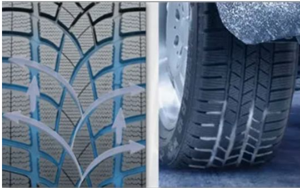
Рисунок 3.2 - Ознаки автомобільних шин стійких до аквапланування
