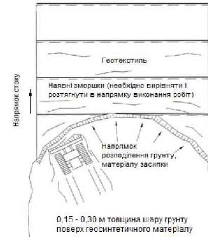
Рисунок 2.5 - Схема насипання ґрунту над полотном геосинтетичного матеріалу на слабкій основі (з модулем деформації більше за 5 МПа)
