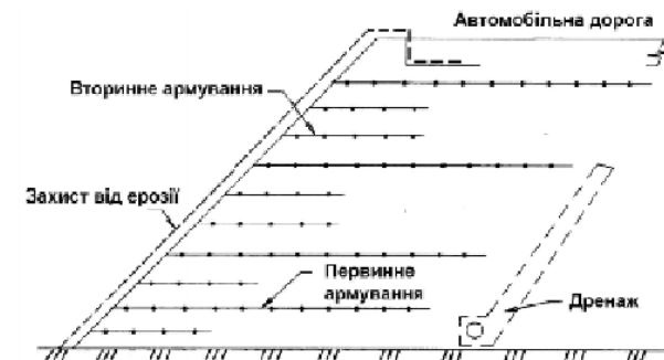
Рисунок 3.1 – Схема армуння і стабілізації укосу насипу
