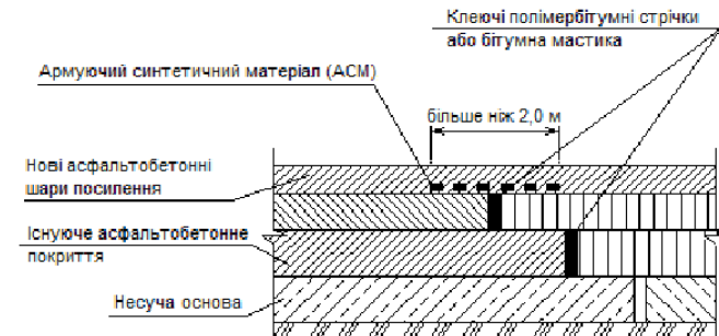
Рисунок 3.10 – Схема поширення конструкції дорожнього одягу з використанням АСМ (вигляд у поперечному напрямку)
